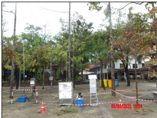
รูปที่ 4.10 การเก็บตัวอย่างคุณภาพอากาศในบรรยากาศ บริเวณโรงเรียนบ้านหนองแพบ
