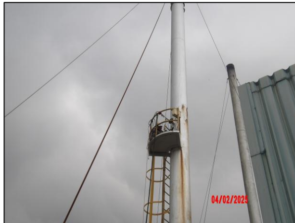
รูปที่ 4.2 การเก็บตัวอย่างคุณภาพอากาศในปล่องระบาย บริเวณ Hot Oil Heater Stack 2 (S-140B)
