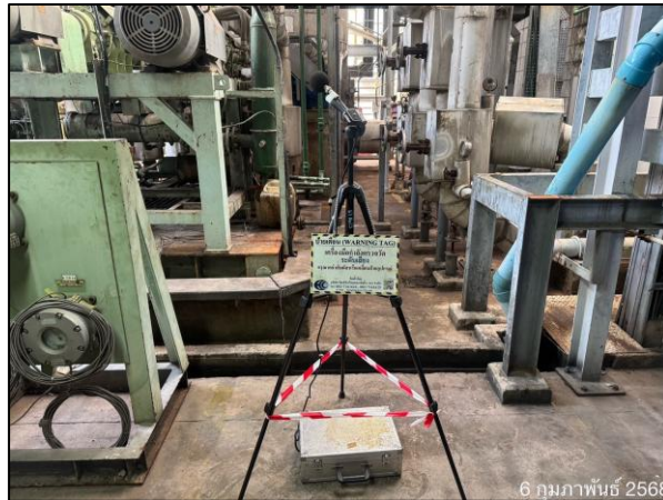
รูปที่ 4.41 การตรวจวัดระดับเสียงในพื้นที่ทำงาน บริเวณ Vacuum Pump
