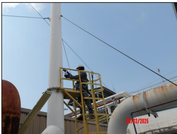
รูปที่ 4.7 การเก็บตัวอย่างคุณภาพอากาศในปล่องระบาย บริเวณ Die-Fume Scrubber Stack of GPPS
