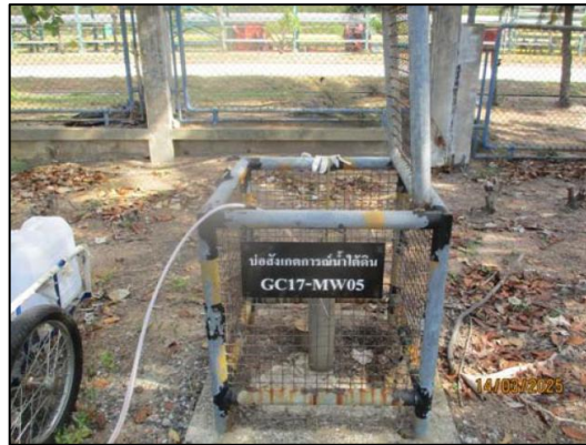
รูปที่ 4.19 การเก็บตัวอย่างคุณภาพน้ำใต้ดิน บริเวณบ่อสังเกตการณ์ MW 05 (เหนือน้ำ)
